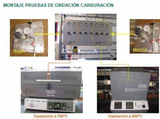
Figura 7: Montaje pruebas de oxidación-carburación simultánea en el Laboratorio de Corrosión a Alta Temperatura en las instalaciones de Plantas Piloto en el ICP.
