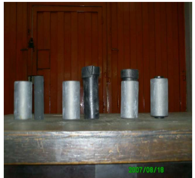
Figura 13. Ubicación del caucho y ensamble de los componentes de un producto.
