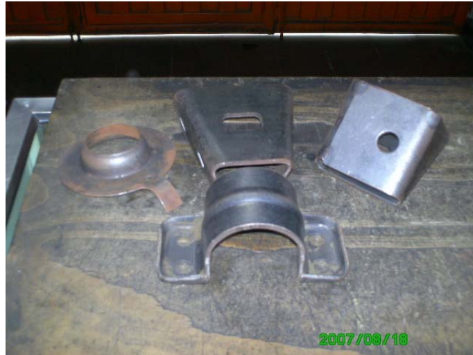
Figura 9. Ejemplo de algunas piezas Troqueladas
