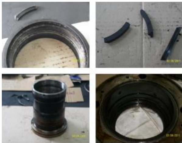
Figura 44. Evidencias de falla en sistemas de sellado.
