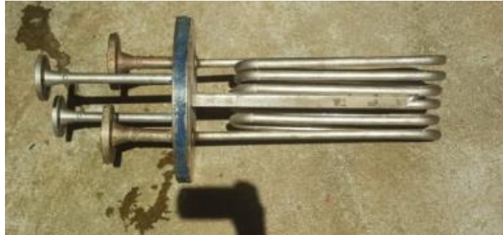
Figura 84. Limpieza mecánica de enfriadores.
