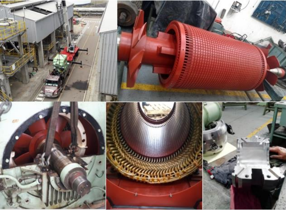
Figura 95. Actividades de mantenimiento general del motor.
