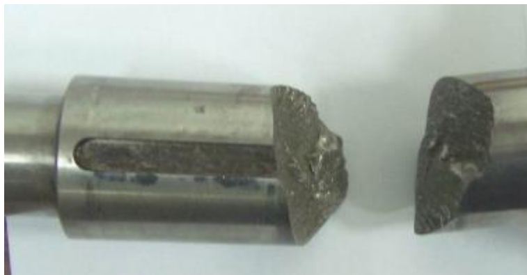
Figura 54. Falla de eje de la bomba.
