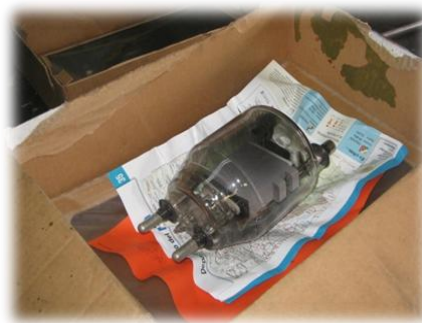
Figura 31. Triodo enfriado por aire. 10000AMP - 10000V
