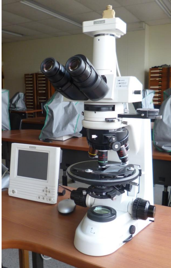
FIGURA 2. Microscopio de luz transmitida Nikon Eclipse-50i con cámara fotográfica.
