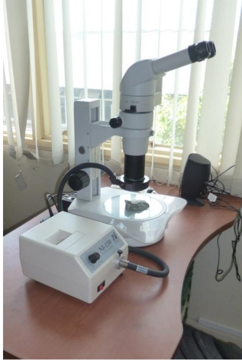
FIGURA 1. Lupa binocular marca NIKON Inc. NI-150 modelo CPS del laboratorio de Estereomicroscopia de la escuela de Geología de la UIS.
