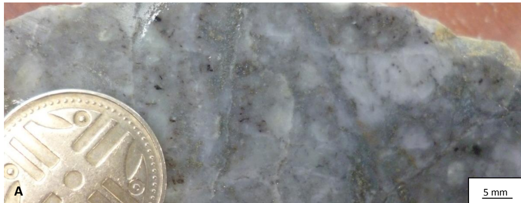
FIGURA 12. A. Aspecto a escala de muestra de mano, del material silicificado, presente a manera de xenolitos al interior del cuerpo ígneo de textura porfírica, reconocido a lo largo de la Galería de conexión. B. Aspecto de un cristal relíctico de molibdenita. C. Biotita, observada al interior del xenolito. D y E. Clorita como producto de alteración de la biotita.
