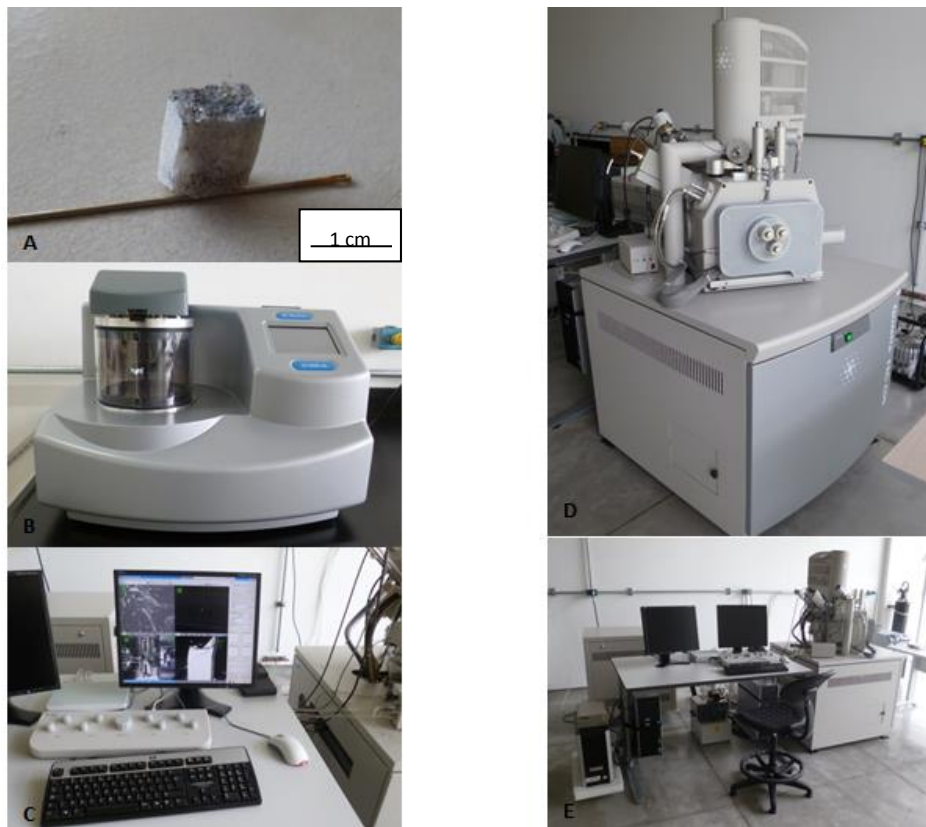
FIGURA 3. A. Muestra de ‘Chip’ de roca para análisis al SEM. B. Metalizador/ Evaporador de carbón QUORUM Q150R. C, D y E. Equipo Quanta 650 FEG SEM ambiental (ESEM) ubicado en la UIS.
