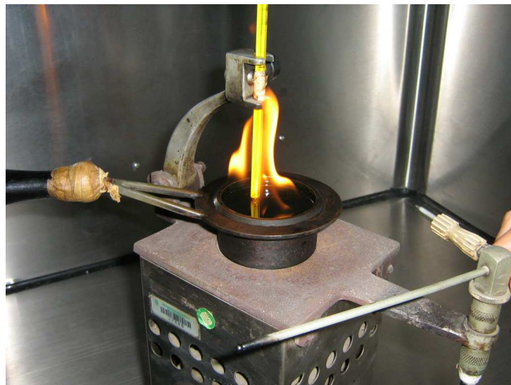
Figura 34. Combustión del Crudo Col 37 por debajo de los 0°C.
