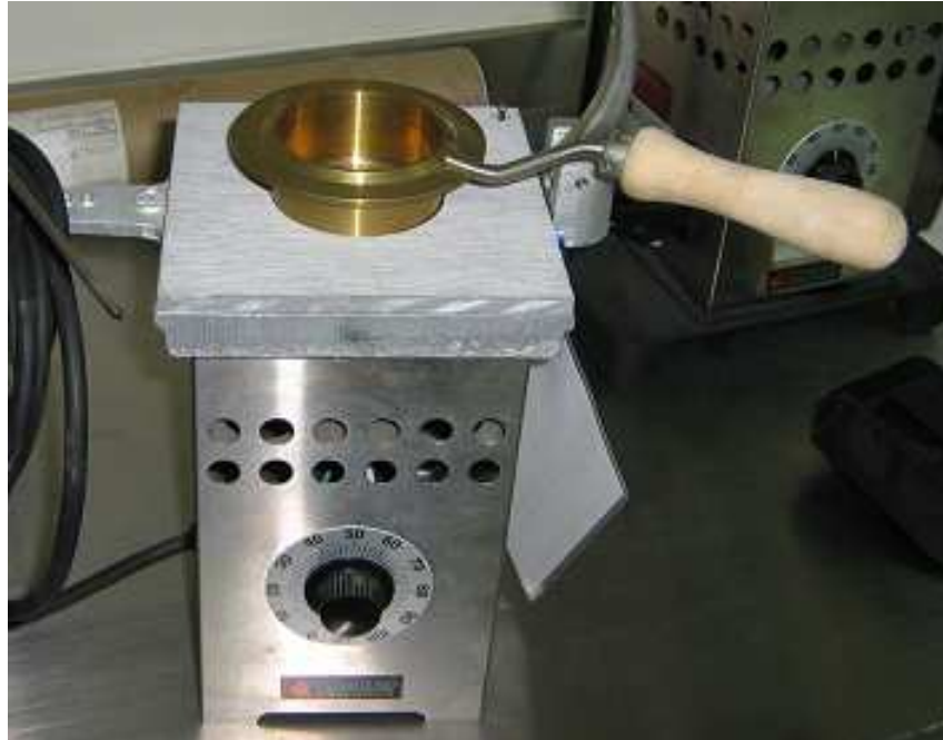
Figura 11. Montaje Copa abierta Cleveland.
