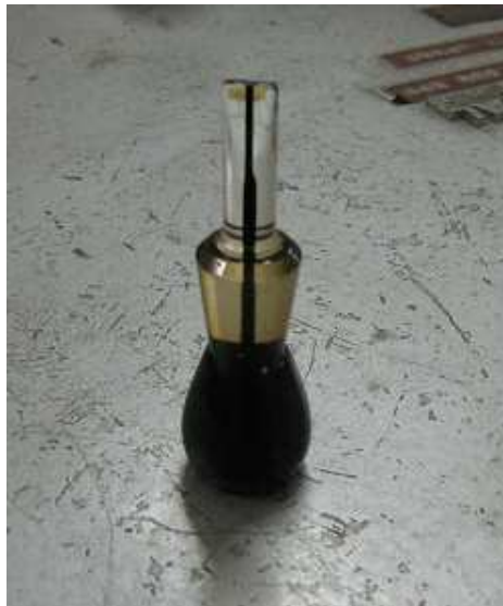
Figura 15. Picnómetro para medir la densidad del crudo.
