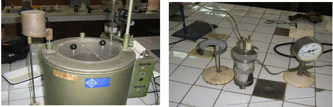
Figura 19. Bomba calorimétrica y sus partes
