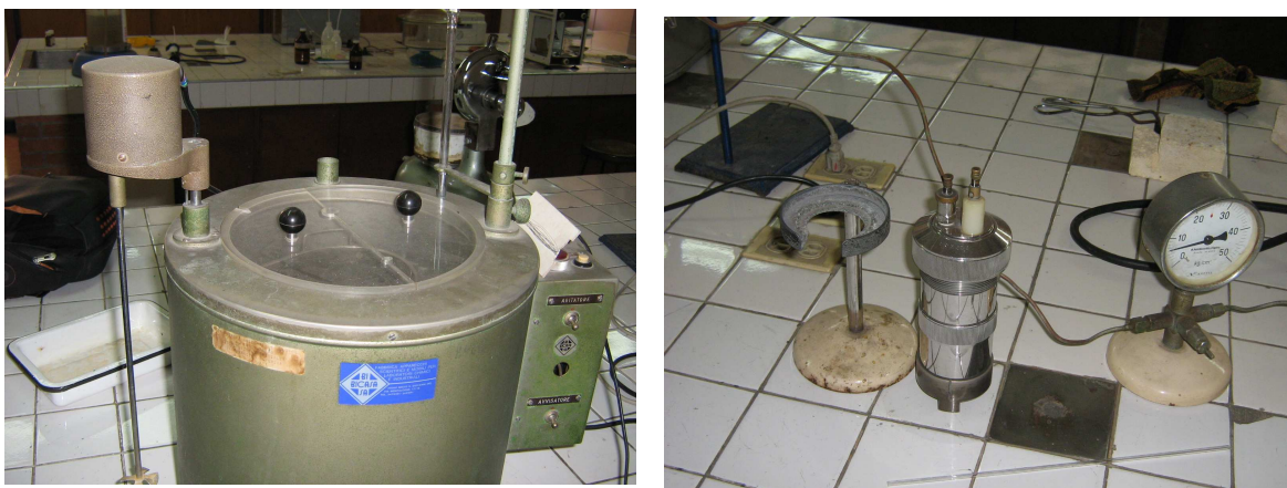
Figura 16. Tanque térmico para introducir la bomba calorimétrica.
