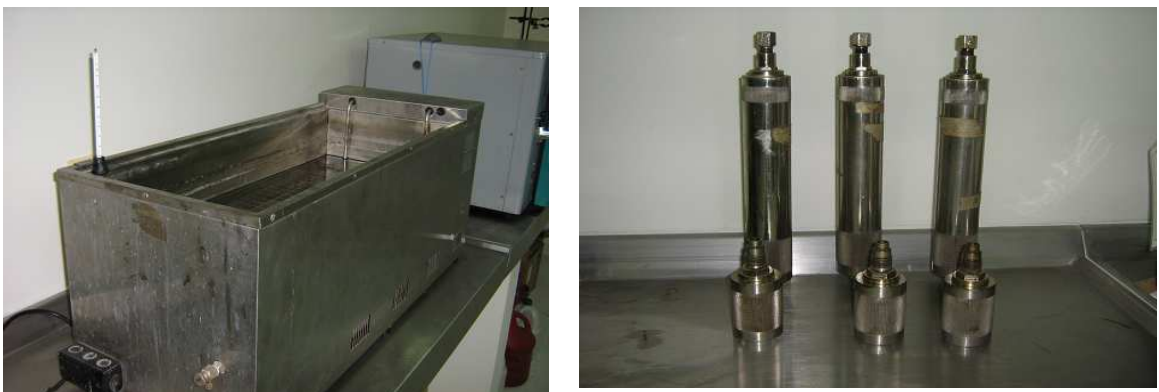
Figura 14. Baño térmico y cilindro para medir presión de vapor Reid.
