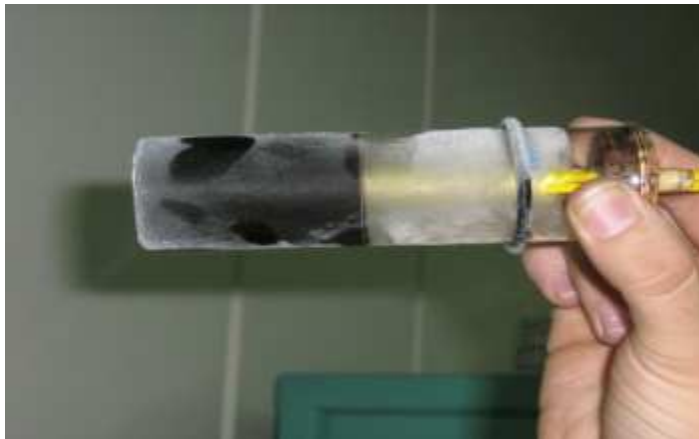
Figura 33. Evidencia del Punto Fluidez del pozo Col 25 a -24°C.
