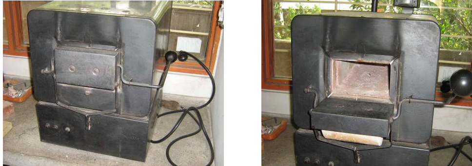
Figura 13. Horno para carbonizar la muestra de crudo y obtener cenizas.
