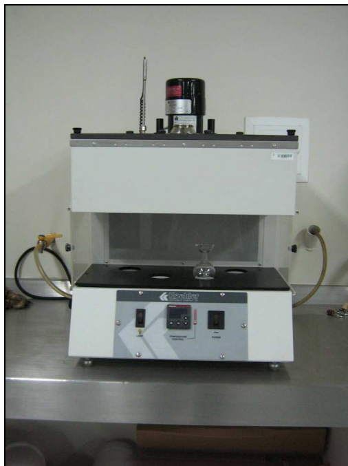
Figura 10. Viscosímetro Saybolt Universal y Furol.
