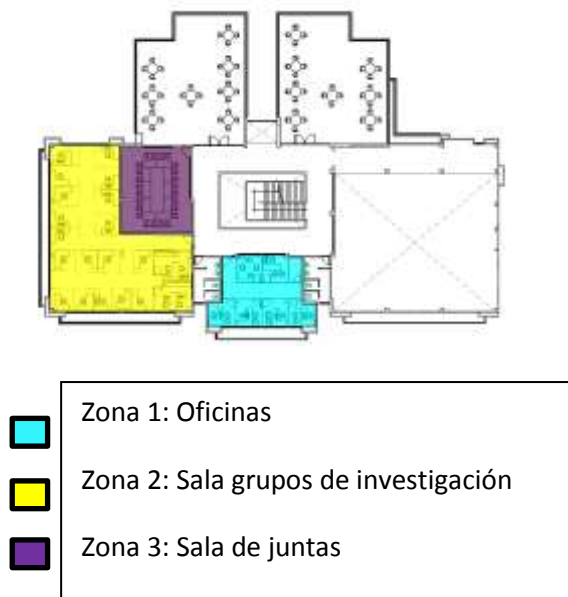
Figura 14. Zonas climatizadas por aires acondicionados en el segundo piso.
