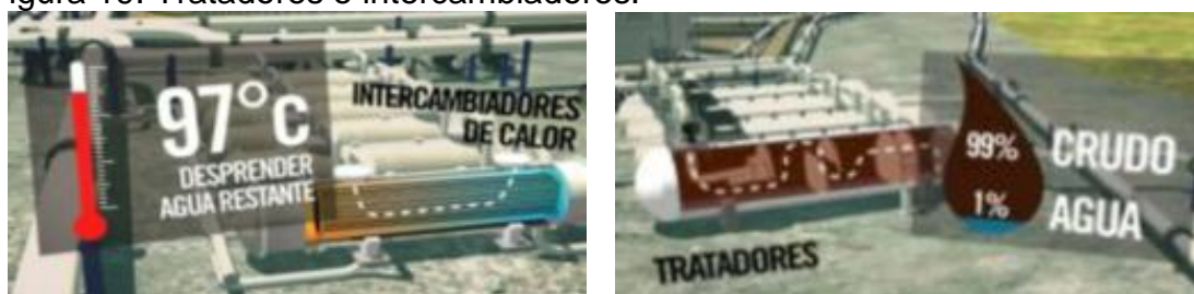
Figura 19. Tratadores e intercambiadores.
