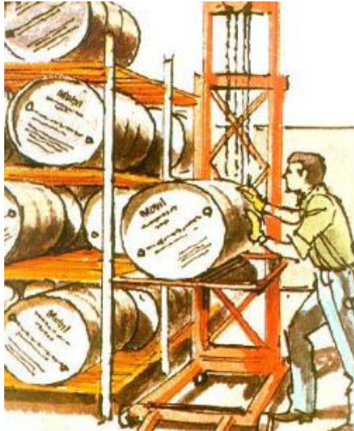
Figura 33. Almacenamiento de lubricantes en estantes.
