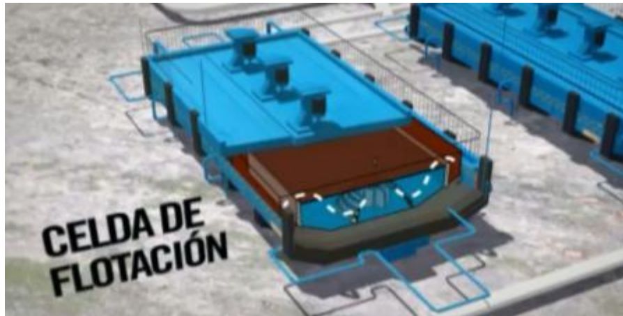
Figura 11. Celda de Flotación.
