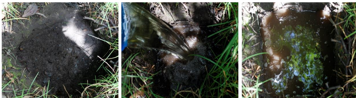
Figura 20. Determinación del drenaje
