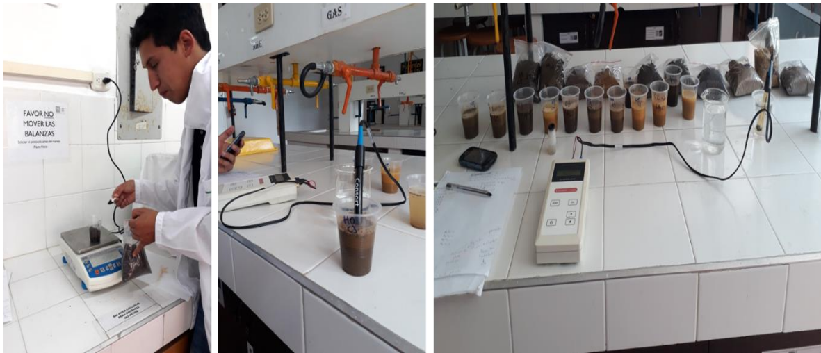
Figura 23. Determinación del pH y conductividad eléctrica.
