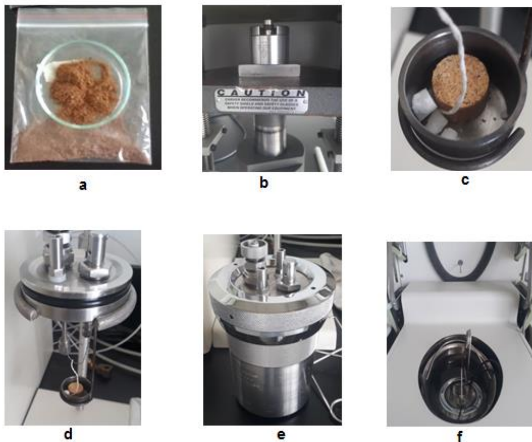
Figura 17. Secuencia del proceso para la toma del poder calorífico de la biomasa.
