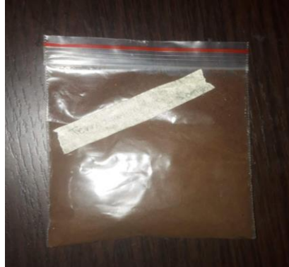
Figura 22. Muestras torrefactadas (30min-275°C) tamizadas en malla 70 para las pruebas de TGA.
