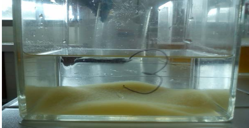
Figura A9. Mezcla de residuos posterior al tratamiento con Policloruro de Aluminio
