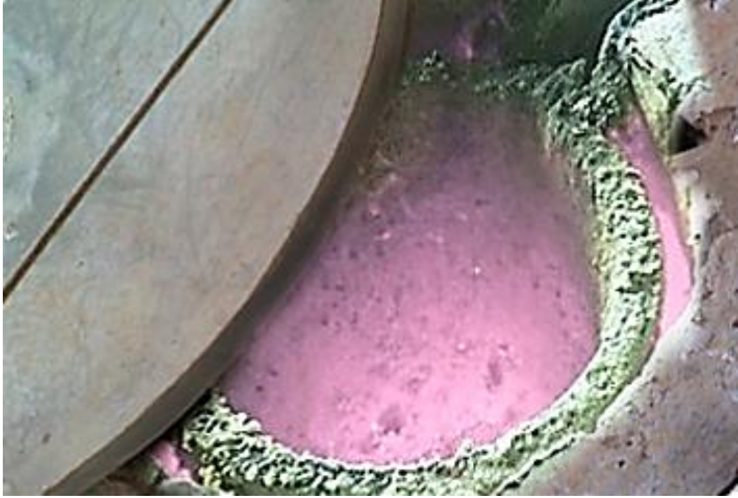
Figura 21. Limpieza y desgasificación de la colada.
