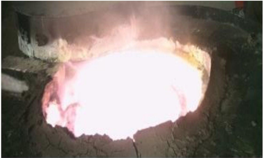
Figura 21. Limpieza y desgasificación de la colada.
