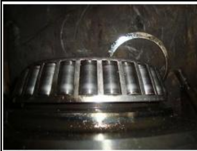
Foto 8. Zonas sombreadas en los rodillos cilíndricos con presencia de desgaste inicial.
