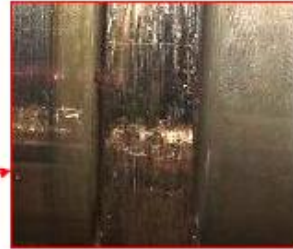
Foto 6. Se aprecia la rueda de acoplamiento del bajo con marcas de adhesión de materia en su zona de deslizamiento, los dientes de contacto tienen un leve desgaste y picaduras.
