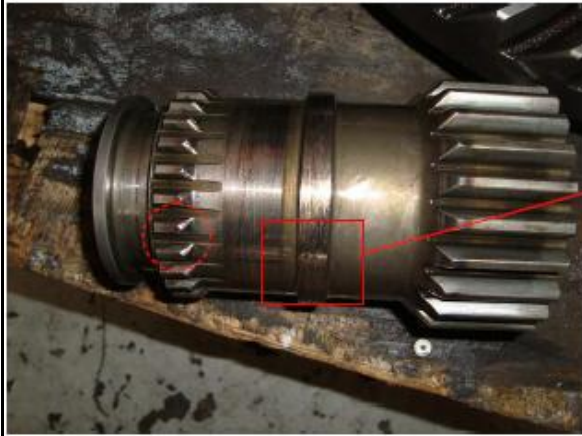
Foto 6. Se aprecia la rueda de acoplamiento del bajo con marcas de adhesión de materia en su zona de deslizamiento, los dientes de contacto tienen un leve desgaste y picaduras.
