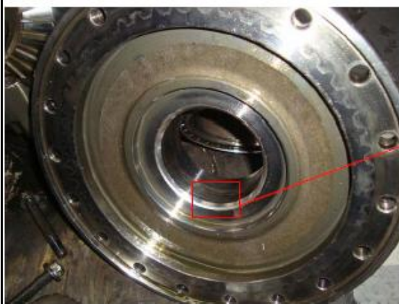
Foto 7. Campana trasera de la corona presenta desgaste adhesivo y abrasivo en la zona de deslizamiento de la rueda de acoplamiento del bajo.
