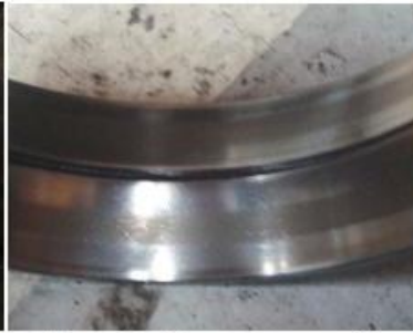
Foto 9. Pista interna del rodamiento presentan desgaste.
