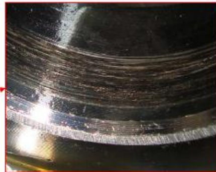
Foto 7. Campana trasera de la corona presenta desgaste adhesivo y abrasivo en la zona de deslizamiento de la rueda de acoplamiento del bajo.
