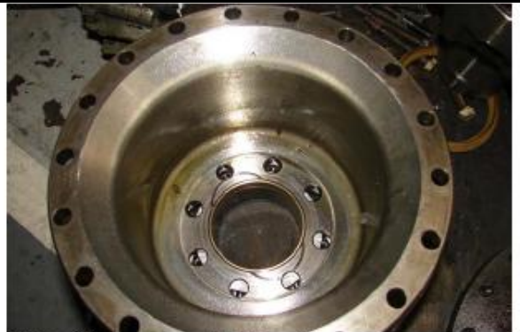
Foto 3. La campana del diferencial no muestra marcas en su parte interna que indiquen un desbalanceo del grupo diferencial o los satélites de acoplamiento del bajo.
