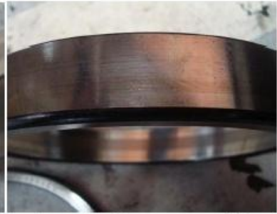
Foto 10. Pista externa del rodamiento NO presenta ningún desgaste o marcas de desbalanceo.
