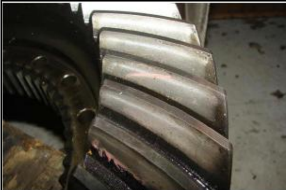
Foto 2. Corona del diferencial, no se aprecia un asentamiento irregular, la zona de trabajo no presenta marcas de adhesión o abrasión y el ajuste con el piñón de ataque es el dado por fábrica.
