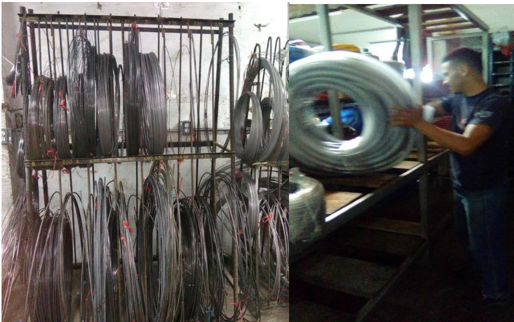
Figura 24. Estantes diseñados para mejorar el almacenamiento y la disposición de los insumos.
