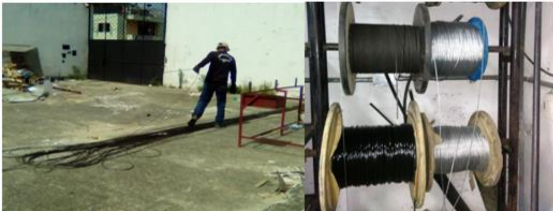
Figura 28. Medición de guaya para su rebobinado en los carretes y etiqueta.
