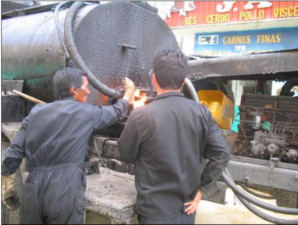
Figura 49. Carrotanque especial para Imprimación
