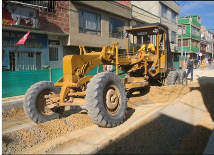
Figura 35. Moto niveladora para extensión y/o mezcla de material
