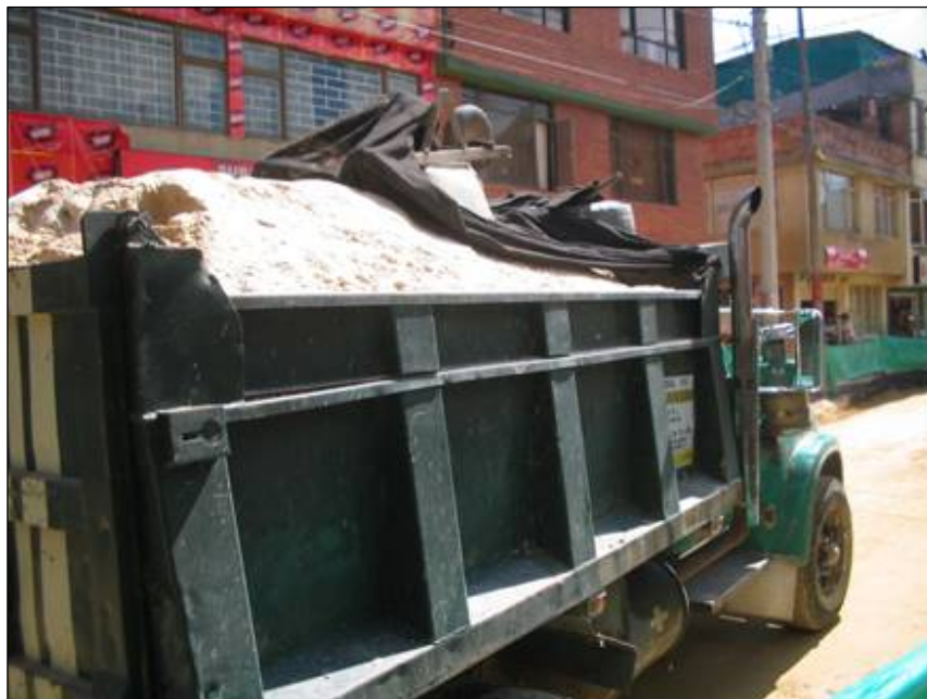
Figura 37. Se observa el cobertor de protección sobre el material cargado
