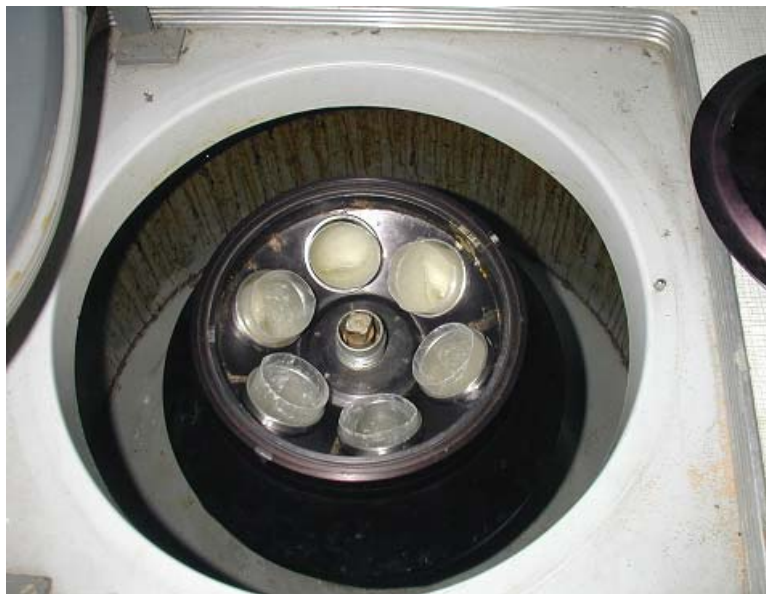
Figura 2. Centrifuga utilizada para la separación de la oleína y la estearina en el aceite de palmiste.
