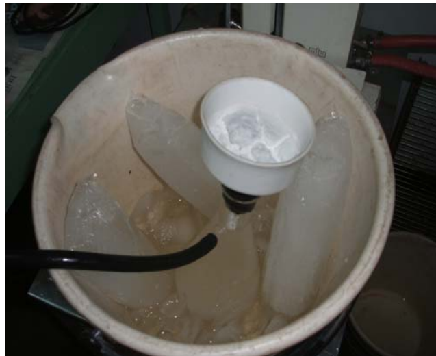
Figura 7. Montaje de la filtración al vacío.
