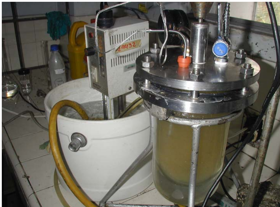
Figura 6. Reactor enchaquetado de vidrio
