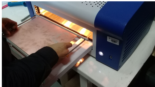
Figura 20: Curado del polímero a 160°C durante 30min.
