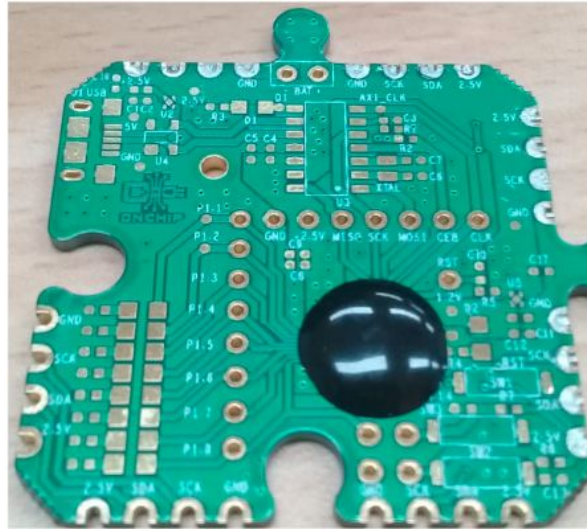
Figura 39: Aplicación de epoxi oscuro para protección de CoB
