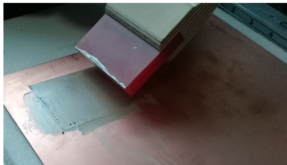
Figura 18: Aplicación del polímero conductor sobre la PCB.
