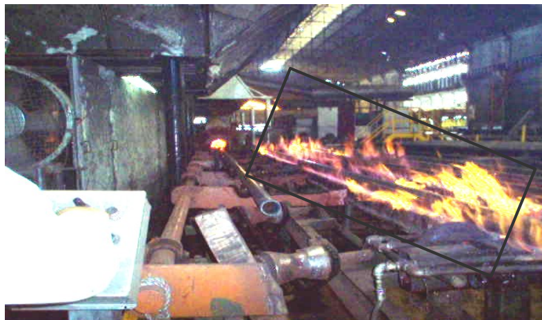
Figura 4. Fotografía del sistema de precalentamiento. Este sistema se alimenta directamente de la línea de gas, con exceso en el consumo de combustible
