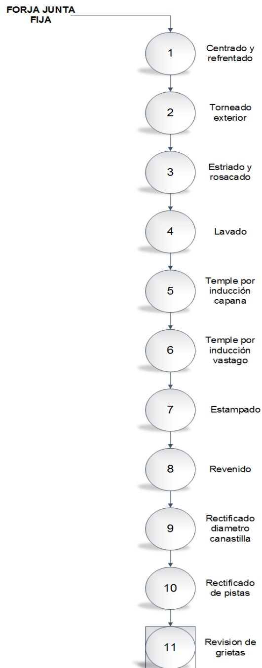
Figura 14. Diagrama de flujo de la línea de Junta Fija
