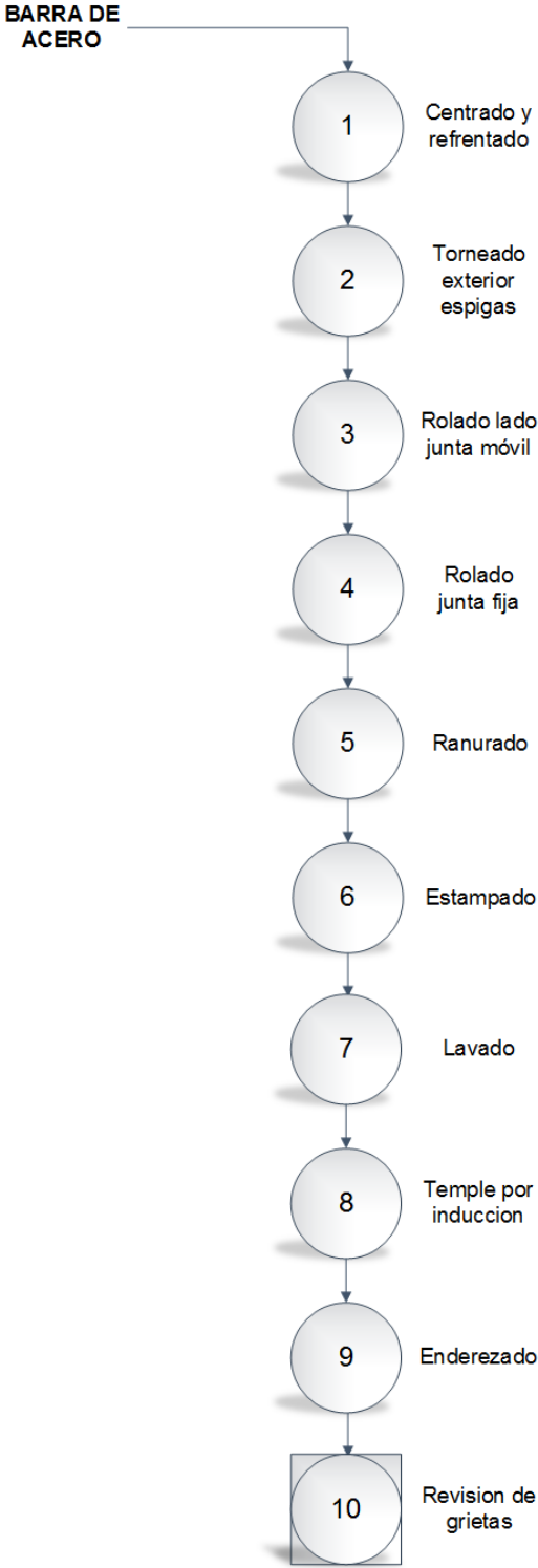
Figura 15. Diagrama de flujo de la línea de Intereje
