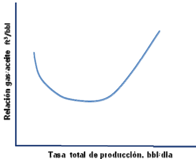
Figura 9. Tendencia en el comportamiento del GOR Vs. La tasa de producción: el mínimo mostrado puede deberse a la estratificación de la formación.
