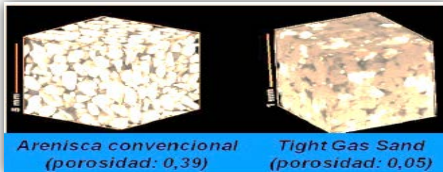
Figura 21: Porosidad en los yacimientos de Tight Gas.
