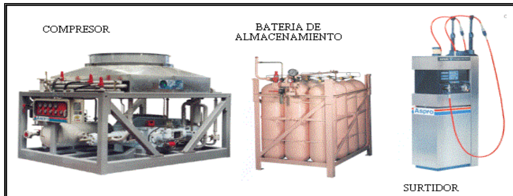
Figura 8. Equipos Requeridos en la Estación Compresora de Gas Natural Vehicular
