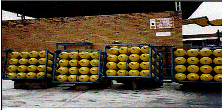
Figura 10. Baterías de Almacenamiento de GNC
