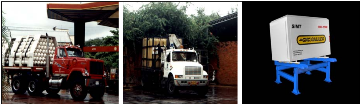
Figura 12. Alternativas de Equipos Requeridos para el Transporte de Gas Natural Comprimido
