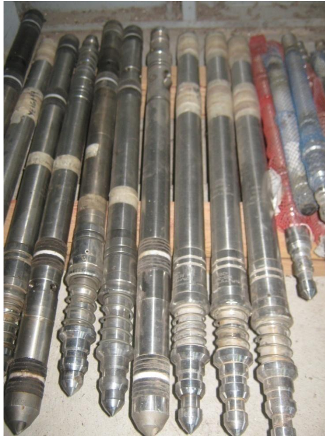
Figura 23: Válvulas de gas lift por presión de Gas R-2
