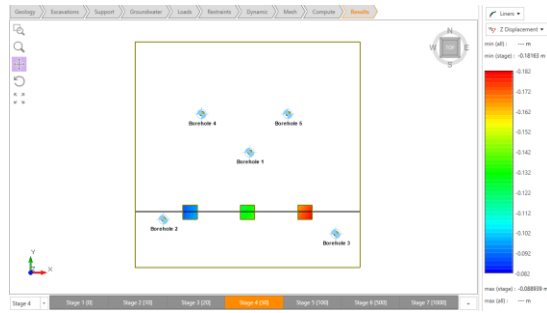
Figura 28. Asentamiento Zapatas Etapa 4
