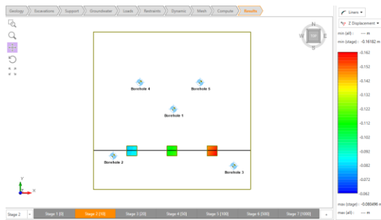
Figura 26. Asentamiento Zapatas Etapa2
