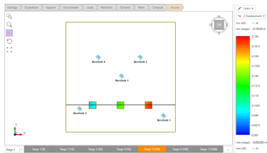
Figura 29. Asentamiento Zapatas Etapa 5
