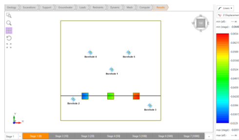
Figura 25. Asentamiento Zapatas Etapa 1
