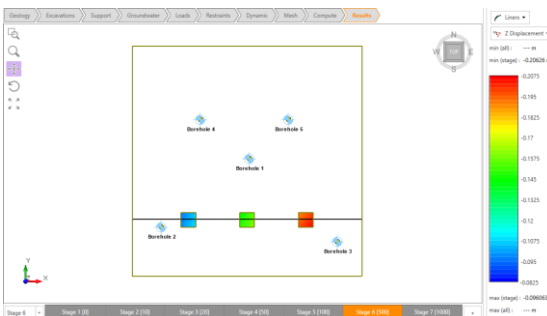
Figura 30. Asentamiento Zapatas Etapa 6
