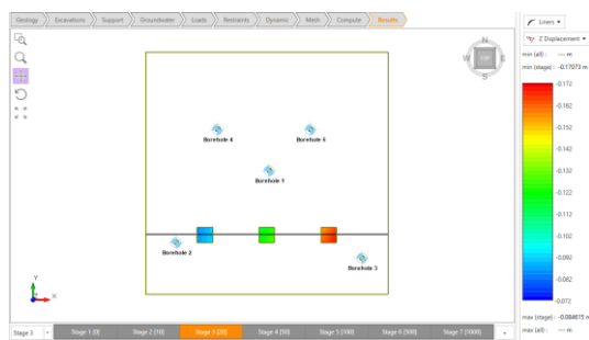
Figura 27. Asentamiento Zapatas Etapa3
