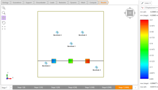
Figura 31. Asentamiento Zapatas Etapa7
