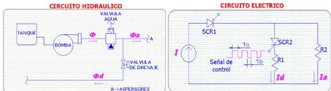
Figura 34. Analogía eléctrica para el sistema hidráulico.
