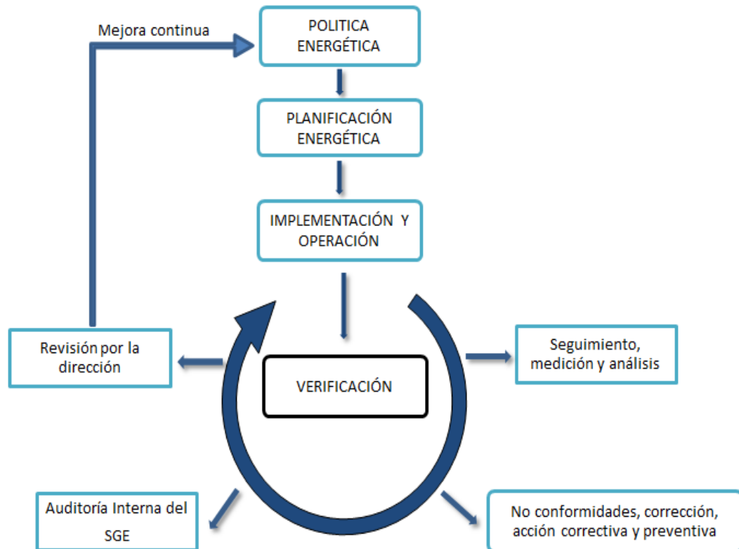
Figura 7 Modelo de gestión de la energía para la Norma ISO 50001 26
