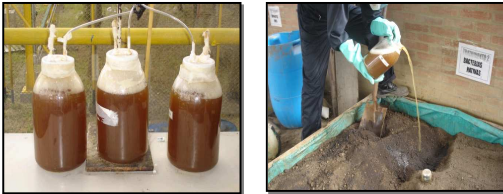
Figura 15 y 16. Biorreactores utilizados para la bioaumentación del consorcio. Adición del consorcio de bacterias nativas al tratamiento de bioaumentación.
