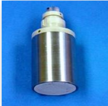
Figura 27. Foto típica de un transductor ultrasónico.
