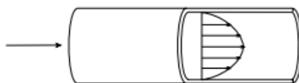
Figura 3. Flujo de Poiseuille en el interior de un tubo. (Universidad de Alicante, s.f.)
