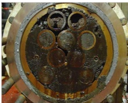
Figura 3. Depósitos de Naftenatos de calcio en un hidrociclón en un campo petrolero costa afuera de Nigeria
