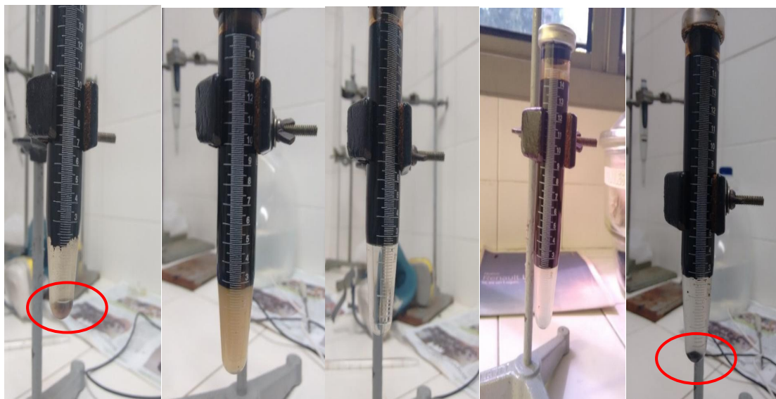
Figura 16. Muestra de crudo con dosificación de rompedor de emulsión a distintas concentraciones a)50 ppm b)100 ppm c)200 ppm d) 500 ppm e)1000 ppm
