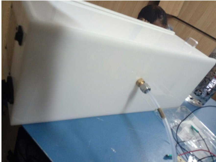
Figura 20. Parte posterior e instalación del racor
