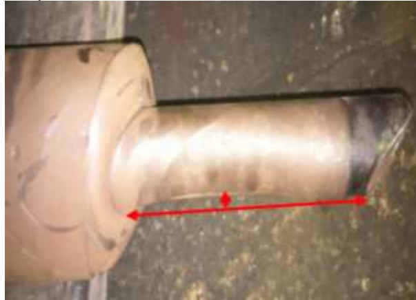
Figura 23. Desgaste del perno resorte.
