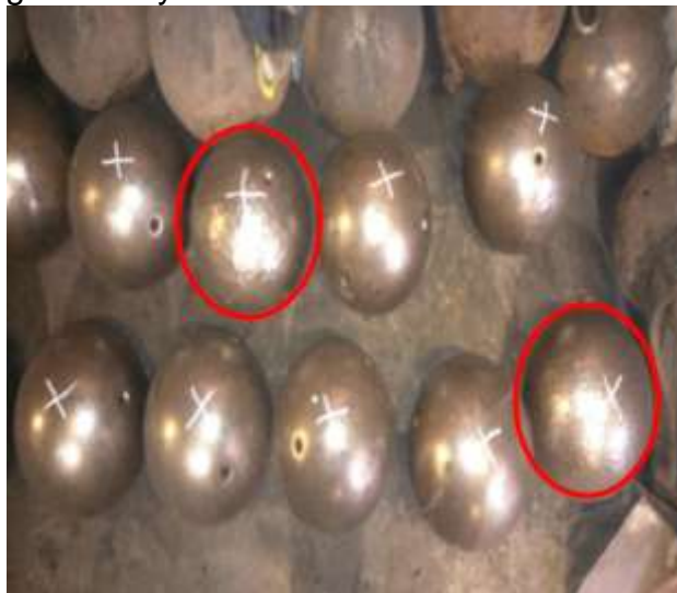
Figura 28. Bolas desgastadas y abolladas.
