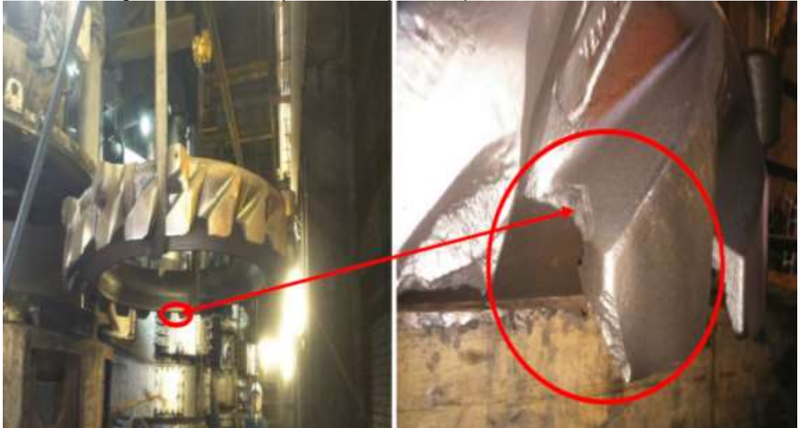
Figura 27. Desgaste dientes separadores pista superior.
