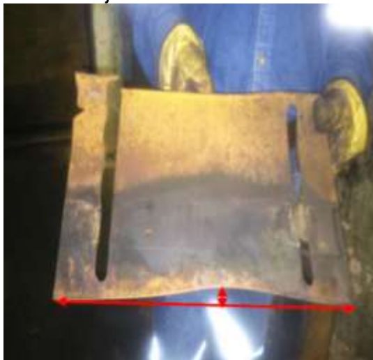
Figura 26. Desgaste láminas ajustables.
