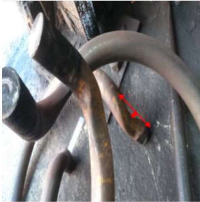
Figura 24. Desgaste resorte helicoidal.
