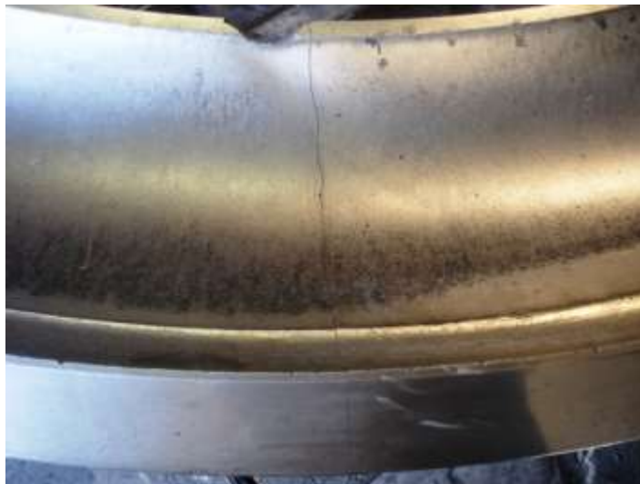
Figura 34. Pista inferior fracturada por alta vibración.
