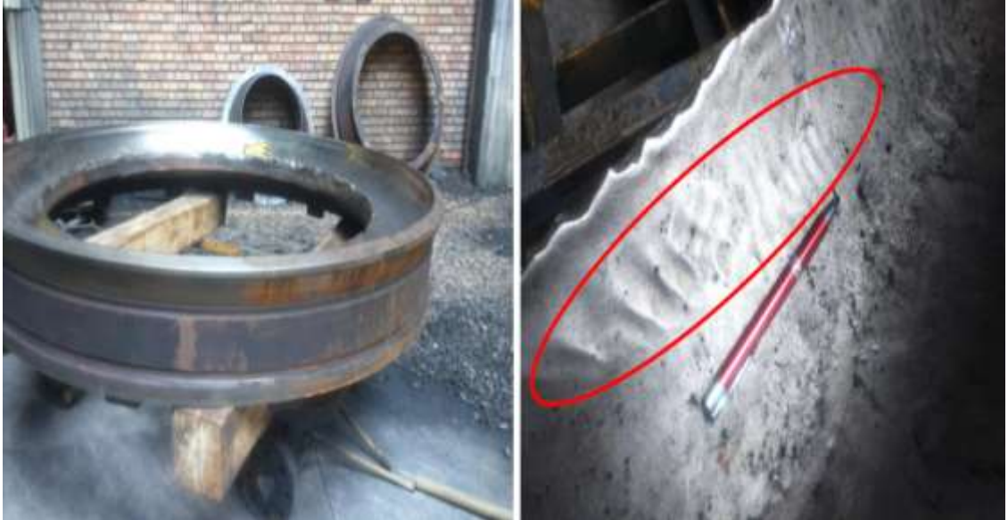
Figura 29. Abolladuras y desgaste pista inferior
