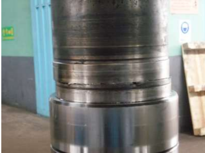
Figura 35. Eje rayado por desalineación.
