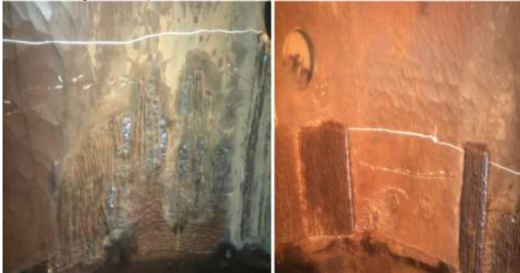
Figura 31. Degaste de paredes del cuerpo.
