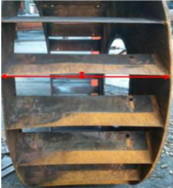
Figura 25. Desgaste soporte láminas del clasificador.
