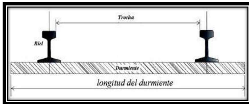
Figura 5. Perfil longitudinal vía férrea.
