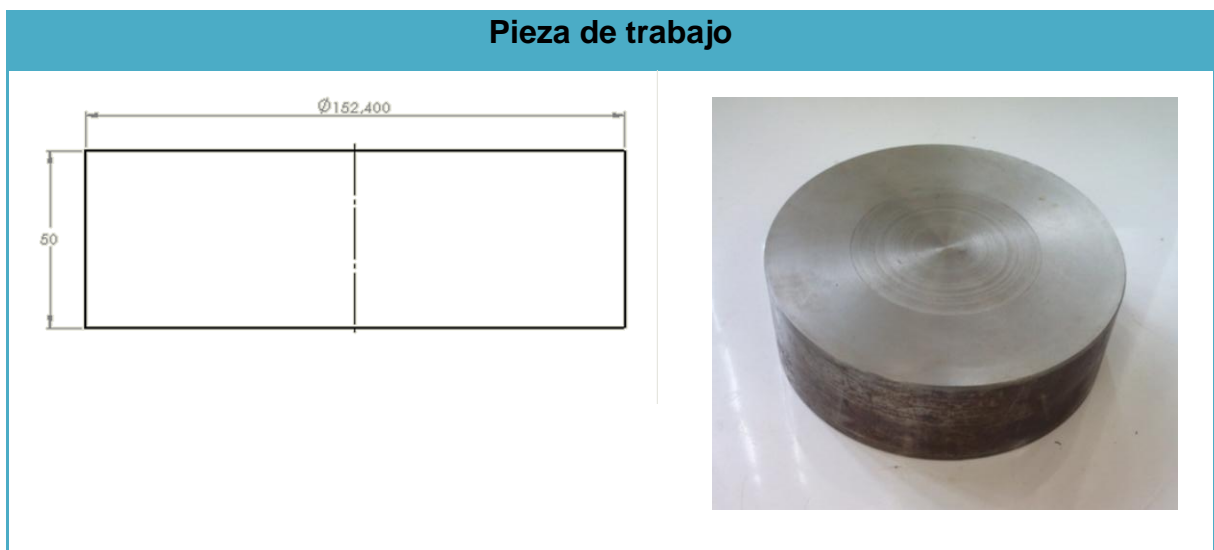
Figura 17. Geometría del material a taladrar.
