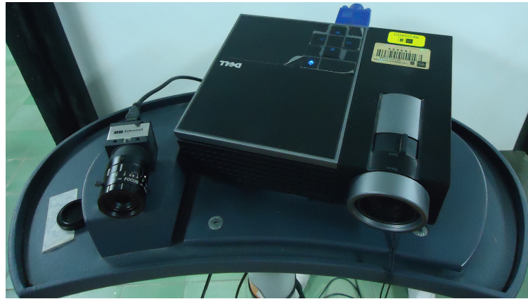
Figura 64: Unidad de proyección-adquisición diseñada por el grupo GOTS.
