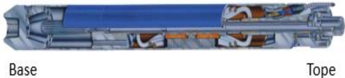
Figura 22. Motor Reda para altas temperaturas.
