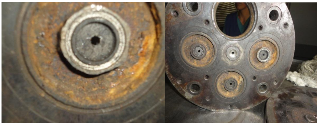
Foto 7. Estado de moldes Acero al carbón
