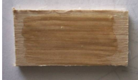
Foto 13. Aplicación de la mezcla de pintura polimérica en lámina de madera
