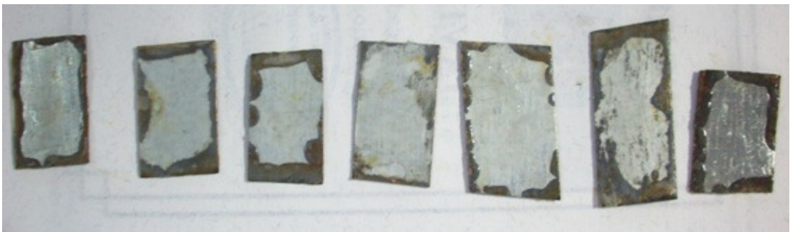
Foto 24. Resistencia al Ácido Nítrico después de una hora
