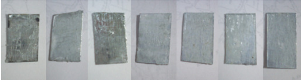
Foto 22. Resistencia al Ácido Clorhídrico
