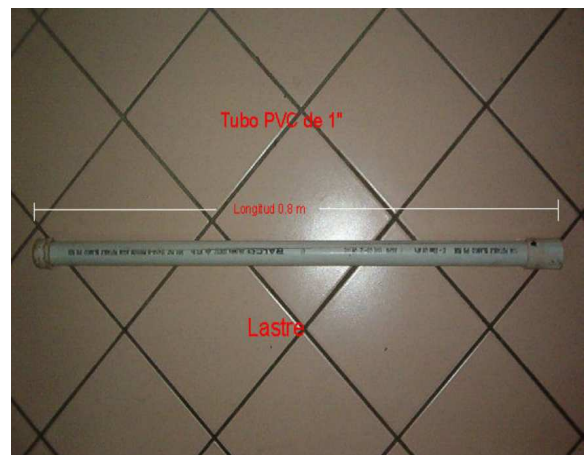
Fig. 9 Dimensiones del lastre.
