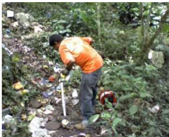
Fig. 17. En campo, abatimiento del nivel del piezómetro
