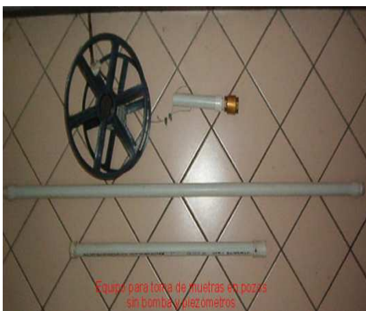
Fig. 8 Bailer, dispositivo para extracción de muestras
