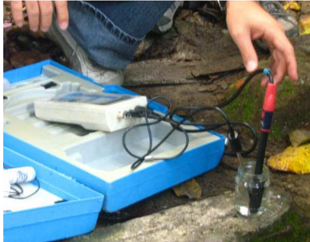
Fig. 11. Medición de factores físico químicos in situ
