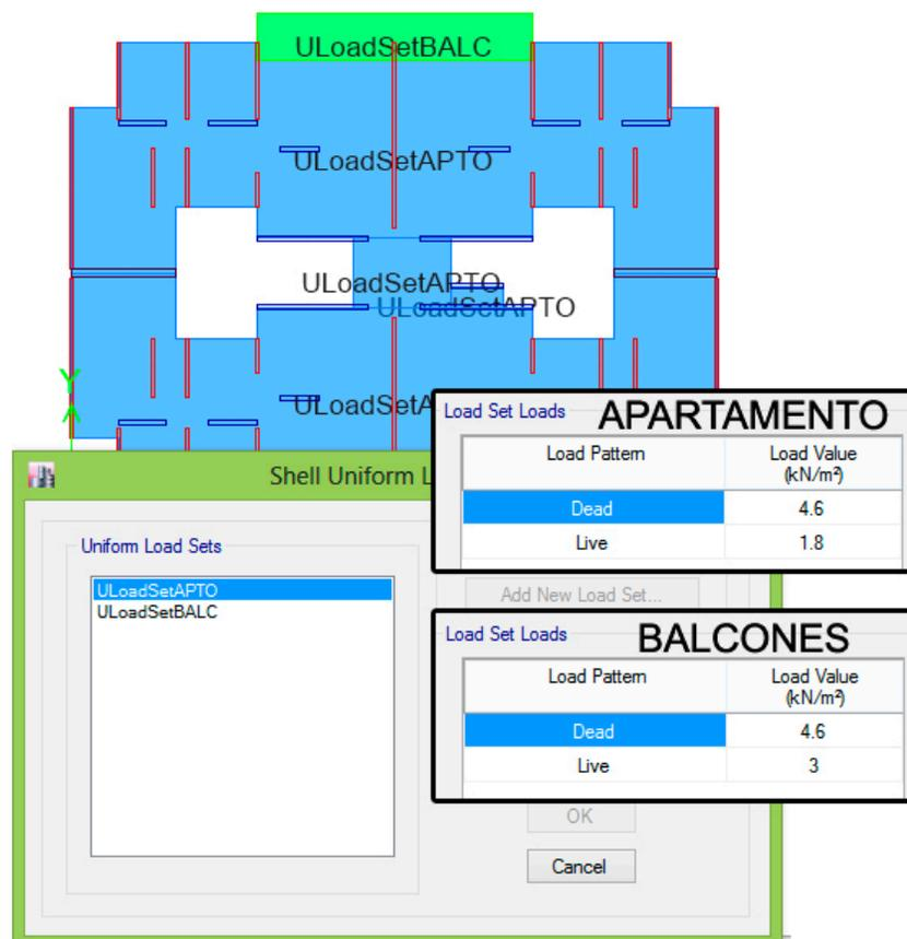
Figura 6 Cargas gravitacionales aplicadas a elemento de losa
