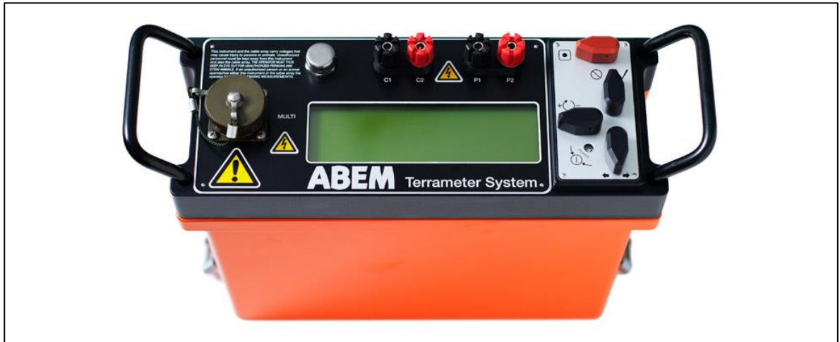
Figura 8. Terrámetro ABEM SAS 1000/4000 utilizado en campo para la adquisición de datos.
