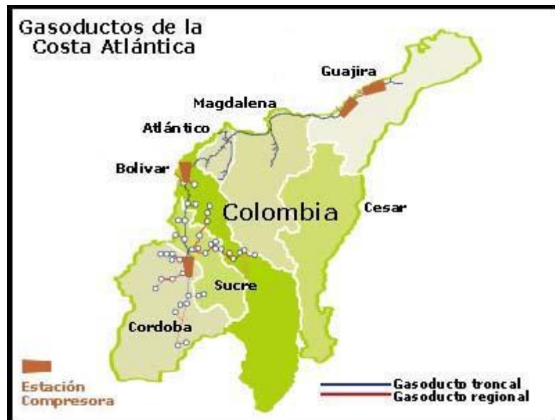
Figura 8. Red gasoducto Promigas
