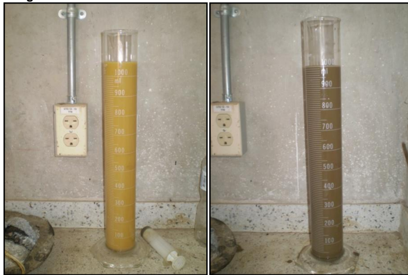
Figura 2-7. Cilindro de sedimentación con dos muestras diferentes.
