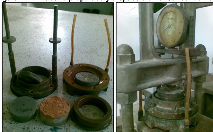
Figura 2-11. Muestra preparada y dispuesta en el Consolidómetro.
