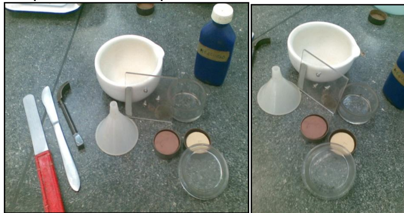
Figura 2-10. Implementos necesarios para realizar el laboratorio de Factores de Contracción.
