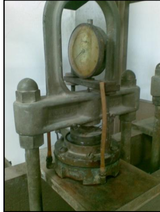
Figura 2-12. Consolidómetro en el ensayo de Expansión Libre.
