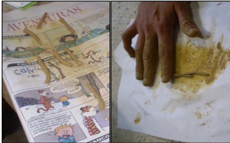
Figura 2-9. Formación de los rollos en el ensayo de Límite Plástico.
