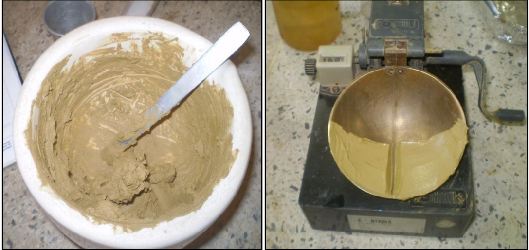
Figura 2-8. Preparación y disposición de la muestra en la cazuela para el ensayo de Límite Líquido.
