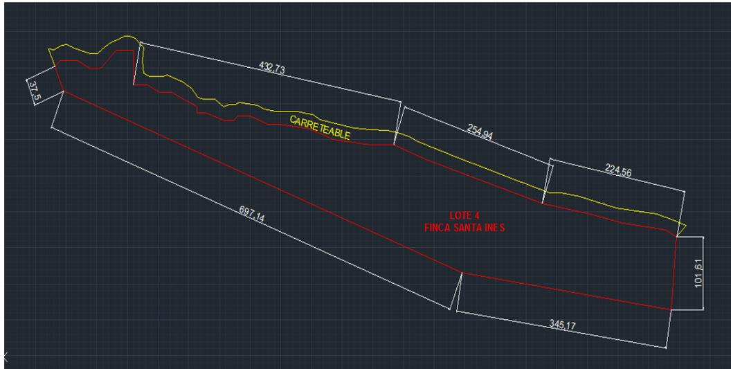
Fuente: Autocad- Levantamiento con GPS realizado por los autores.
