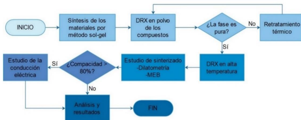
Figura 3. Flujograma general del estudio de materiales (Y,Zr)(Mn,Ti)_{1-x}O_{3-\delta} .
