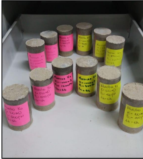
Figura 19. Primer fase de plugs siguiendo protocolo propuesto en el Apéndice A.
