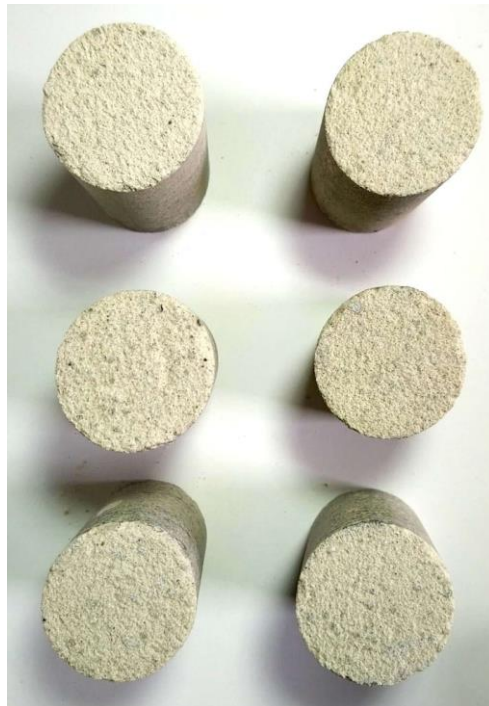
Figura 21. Fase de plugs construidos compactando en el tope a 400 psia y alta solución epóxica
