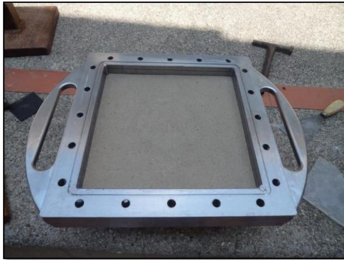
Figura 11. Compactación manual del medio poroso. Celis, L. y Fernández de castro, O. (2012). Estudio experimental de procesos de inyección de agua en el equipo de desplazamiento radial con medios porosos estratificados (Tesis de pregrado). Universidad Industrial de Santander, Bucaramanga, Colombia.
