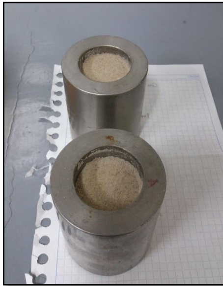
Figura 40. Enfriamiento de los moldes y curado de las muestras.
