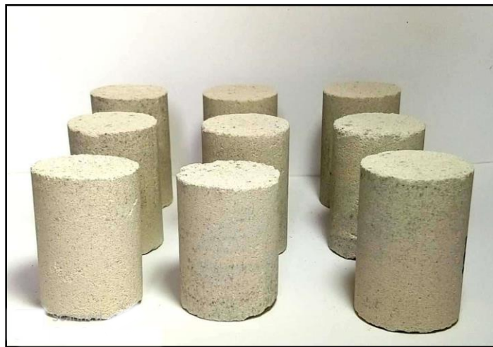
Figura 30. Muestras compactadas a 400 psi solo tope y baja solución epóxica
