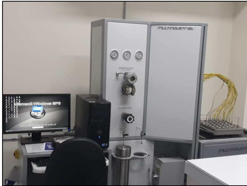
Figura 9. Equipo de Desplazamiento Radial – Grupo de Investigación de Recobro Mejorado UIS (2019). Equipo de Desplazamiento Radial (EDR). Recuperado de http://grmuis.net/?page_id=3930
