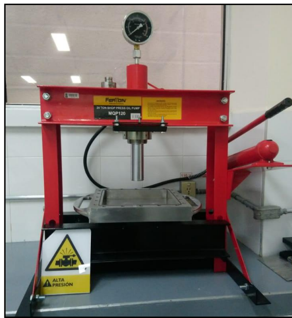
Figura 15. Prensa Hidráulica – Equipo de Compactación de medios porosos en forma de Paralelepípedos.
