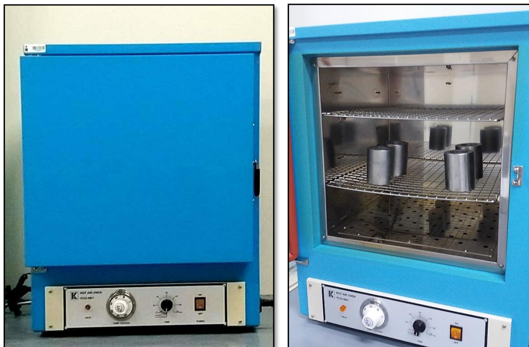
Figura 39. Llevado al horno a 90°C para el curado de las muestras
