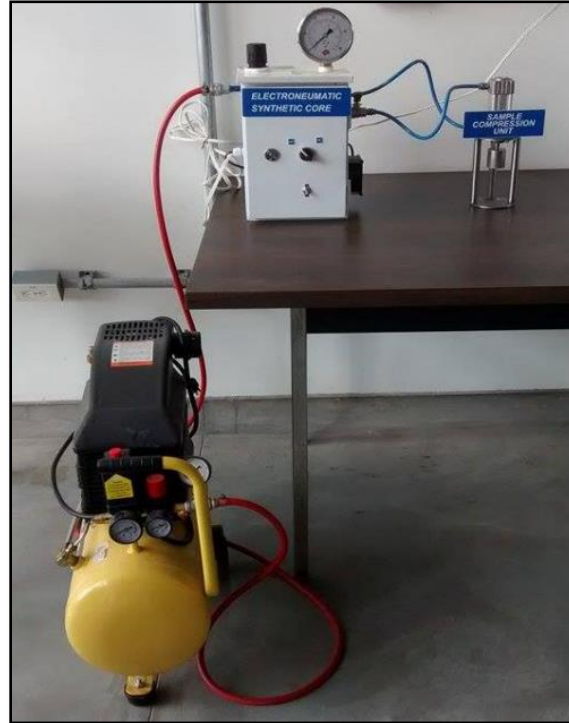
Figura 13. Equipo electroneumático - Cáceres, J. y Porras, K. (2015). Construcción de equipo electroneumático para la fabricación de medios porosos sintéticos (Tesis de pregrado). Universidad Industrial de Santander, Bucaramanga, Colombia.
