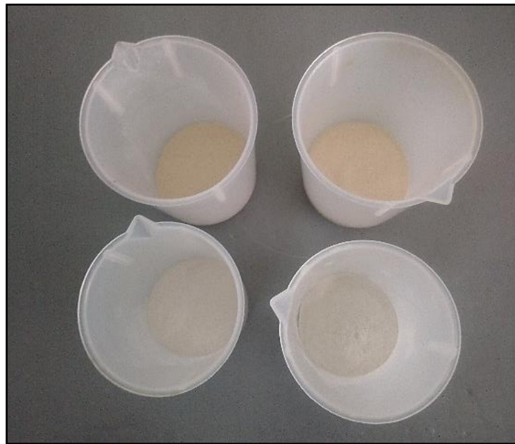
Figura 37. Cálculo de proporciones y mezclado de arena Ottawa 80/100 y caolín.
