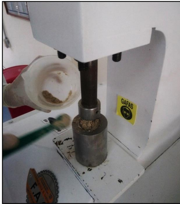
Figura 38. Mezclado y llenado de moldes.
