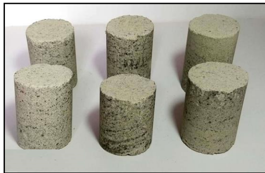
Figura 26. Muestras Fase 2 a 1.200 psi – Baja solución Epóxica.
