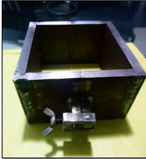
Figura 44. Molde de acero para la construcción de medios porosos en forma de paralelepípedos
