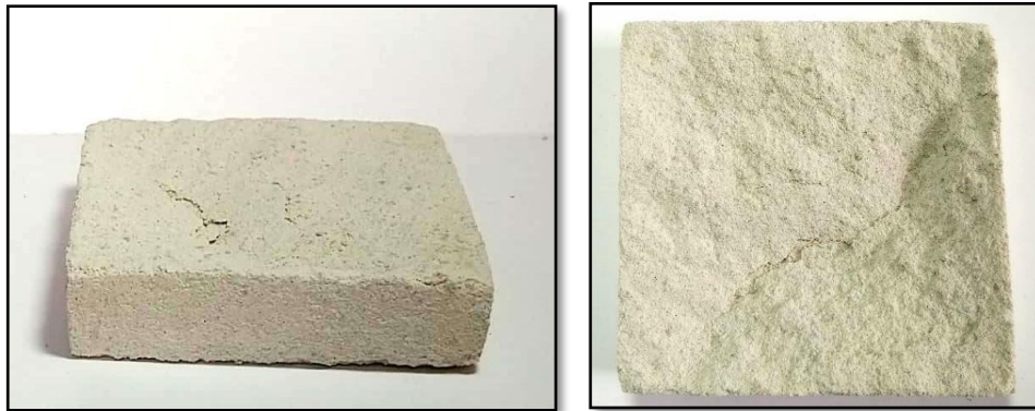
Figura 50. Paralelepípedos intermedios a 400psia – BT-3.5-(E)
