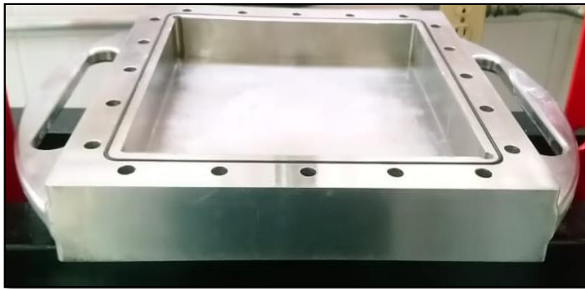
Figura 10. Porta núcleos de acero inoxidable del Equipo de Desplazamiento Radial
