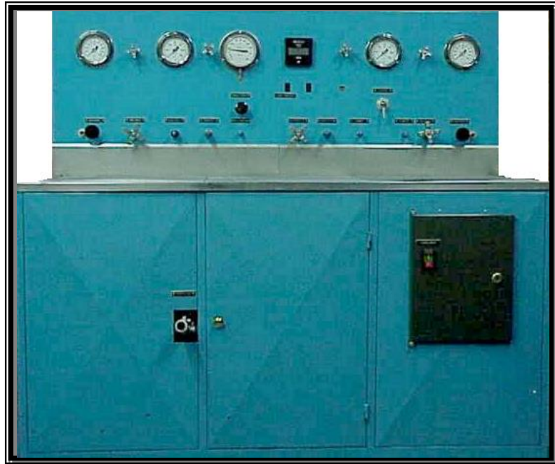
Figura 2. Banco hidráulico para prueba de accesorios hidráulicos de aviones y helicópteros JG-001
