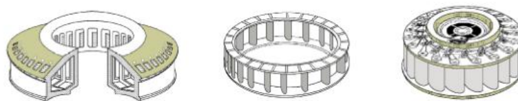
Figura 4. Álabes directrices de un distribuidor
