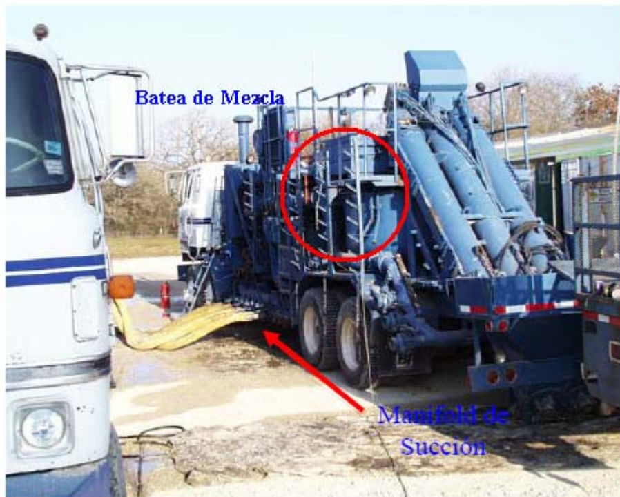
Figura 15. Batea de mezcla y manifold de succión
