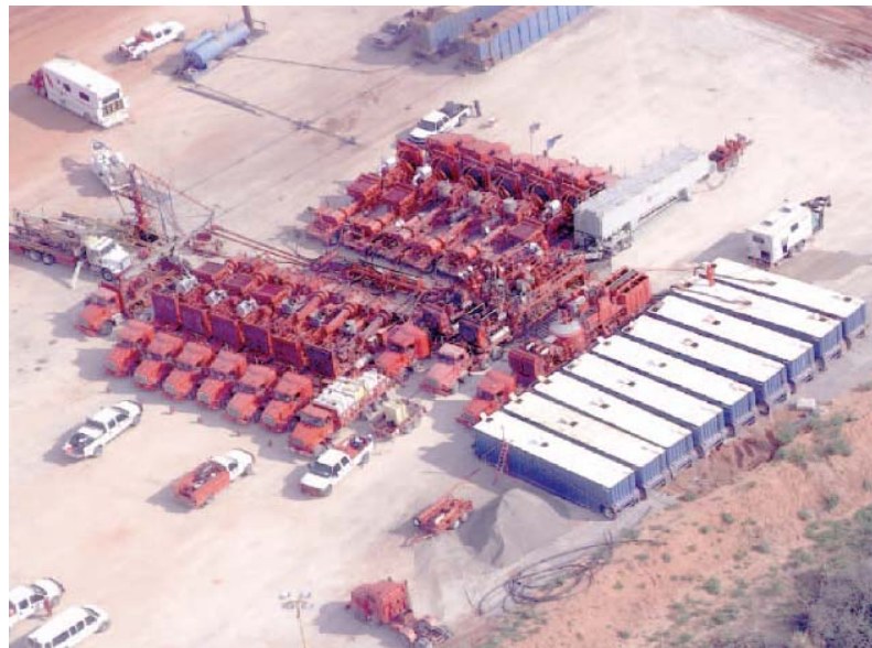
Figura 9. Movilización de equipos para fracturamiento hidráulico
