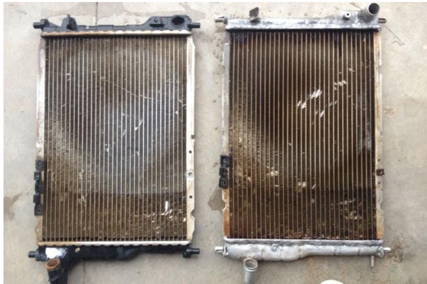
Figura 27. Cambio de tanques plásticos por aluminio al radiador
