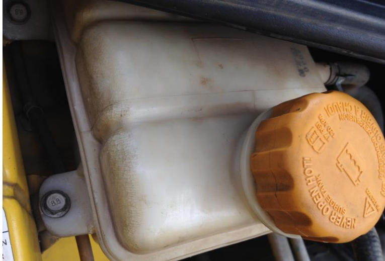
Figura 28. Tanque de almacenamiento cristalizado circuito de refrigeración
