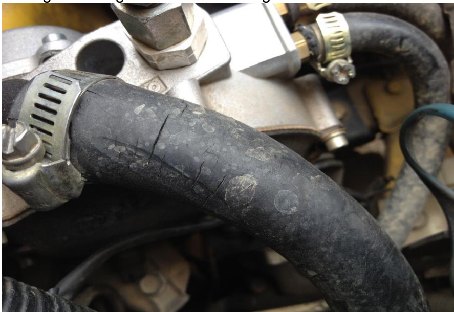
Figura 29. Manguera desgastada sistema de gas natural vehicular
